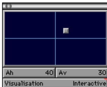
La palette d'axonométrie permet de choisir les angles de vue dans la vue axonométrique interactive du modeleur.
