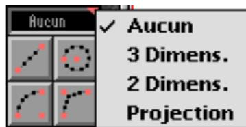
4 modes d'accroche permettent de se caler sur une géométrie existante pour créer une nouvelle entrée. Un menu se déroule de ce bouton et permet de choisir entre ces 4 modes.
